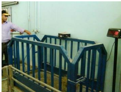
شکل : ترازوی دیجیتال تا ۳ رقم اعشار برای توزین گوسفند
