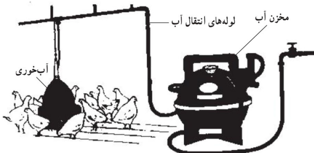
شکل ۶۱-۴- تجهیزات توزیع آب مکانیزه
