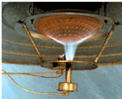
شکل ۳۰-۴. چگونگی توزیع شعله روی بازتابنده سرامیکی
