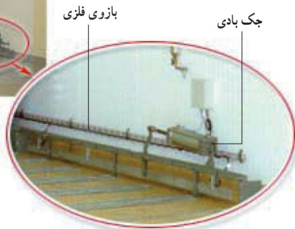
شکل ۱۱-۴- چرخاندن تخم مرغ ها به وسیله ی جک بادی در جوجه گذار
