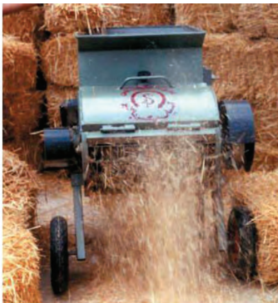
شکل ۵-۳- نحوه کار کاه خردکن
